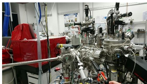
PLD装置とSHGによる強誘電性の観測
