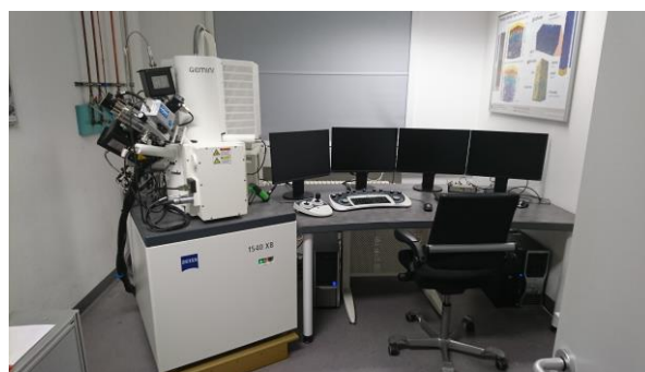
集束イオンビーム機能を搭載した 走査型電子顕微鏡
