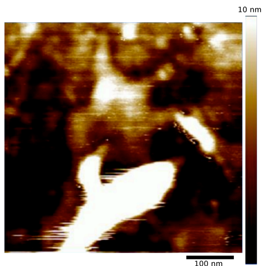
図 3. MCH で修飾した金基板表面の AFM 画像.
