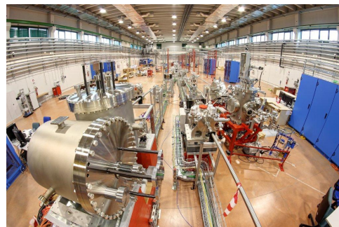
図 2 自由電子レーザー施設 FERMI の実験ホール。3 本のビームラインがあり、左から LDM、DiProI、TIMEX ビームライン。
